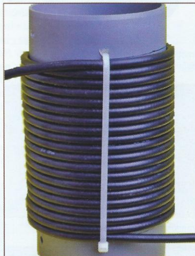
Imagen 6. Aspecto de un choque de RF con núcleo de aire
